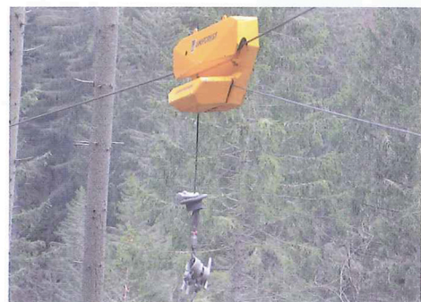
Voziček, končnik, čoker zanke in dodatne uteži takoj nad končnikom (pri dolgih linijah so potrebne, da se vlačilka sploh spusti na tla).
