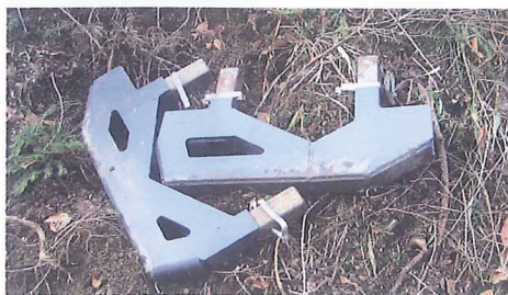
Podporne noge, ki skrbijo za stabilnost stroja, kadar je "odpet in parkiran v garaži".
